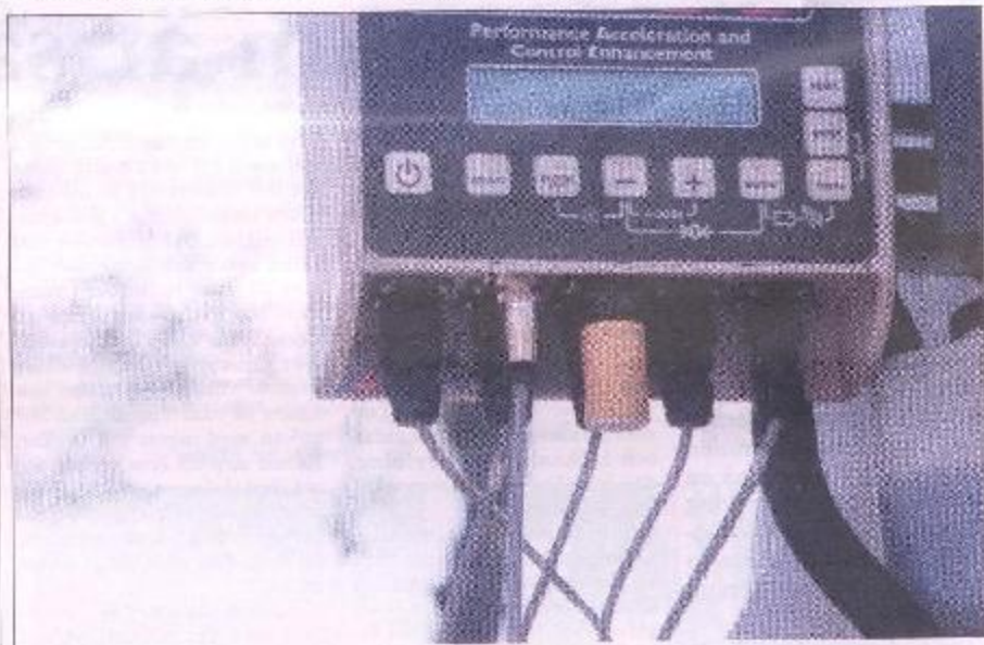
För att kunna använda detta nya koncept som Keenan har, måste man placera ett vägsystem på sin vagn och där läser man vikten på sitt foder som blandas i vagnen. Men kan inte fuska för vagnen går inte vidare förrän fodermedlet är nollat till nästa fodermedel.
